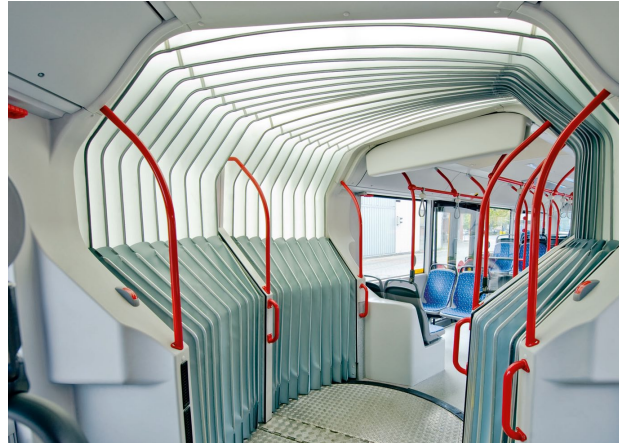
Translucide mais pas transparent : PTO fournit à la maison mère Hübner de Kassel ces matériaux pour soufflets.
